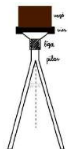
imatge 100. Dibuix de l'estructura. Imatge pròpia.
