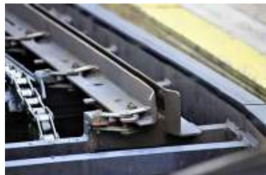
imatge 45. Sistema de frens d'aleta, on es poden observar les plaques per les quals es paren els vagons. Imatge extraïda de https://www.shutterstock.com/es/image-photo/close-roller-coaster-friction-brake-parts-774412159
